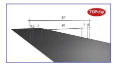
Seitlich mit Nägeln oder Schrauben auf dem Untergrund befestigen. Abdeckung einhängen. Stoßfuge von ca. 5 mm belassen.
